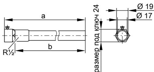
Для датчика или чувствительного элемента регулирующего устройства следует применять прилагаемую к комплекту поставки погружную гильзу из нержавеющей стали. Благодаря этому обеспечивается достижение максимальной эксплуатационной надежности.
