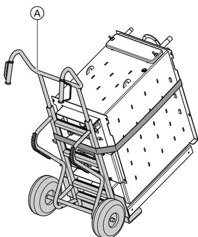
Поставляемая в качестве принадлежности тележка для транспортировки и подачи на место установки (A) используется для перевозки котла по коридорам и лестничным клеткам. Для транспортировки по лестницам требуются 3 - 4 человека.
